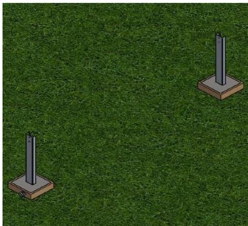
6 - As vigas ficarão conforme a imagem, lembrando da altura de 60cm da parte superior da viga até o solo, sempre respeitando o nivelamento.
