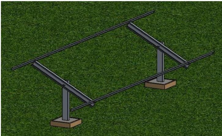
10 - Instalar as longarinas de fixação das placas (peça 3) com o auxílio de uma furadeira
