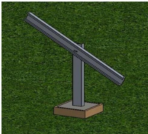
7 - Após a cura de 12h da concretagem, instalar as vigas inclináveis (Peça 2), acertando a angulação com o auxílio de um transferidor ou goniômetro conforme projeto.
