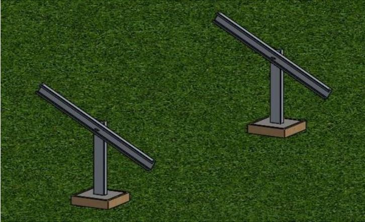
9 - Deve-se nivelar as superfícies das vigas inclináveis para não gerar torção nas placas quando forem instaladas.
