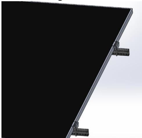
17 - Na última placa, novamente, a fixação é feita com o grampo final (peça 4) e com o conjunto de fixação (barra roscada M6, 2 porcas auto-travantes e 2 arruelas lisas).
