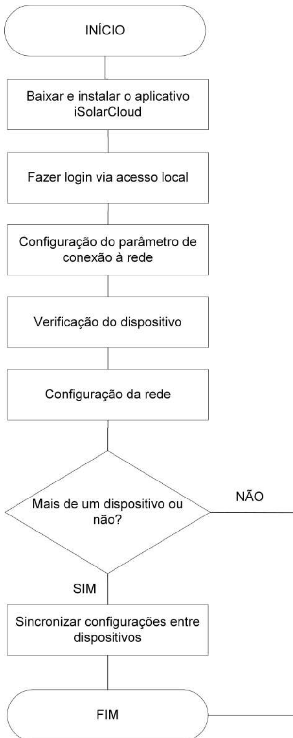
Figura 5-2 Gráfico do fluxo de configuração da operação de conexão à rede
