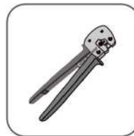
Alicates de crimpagem de terminal OT (de 4 a 6\text{ mm}^2 )
