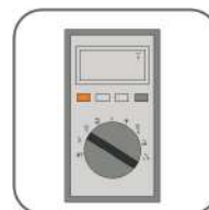
Multímetro ( \geq 600 Vdc)
